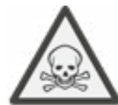
Caution Harmful fumes
